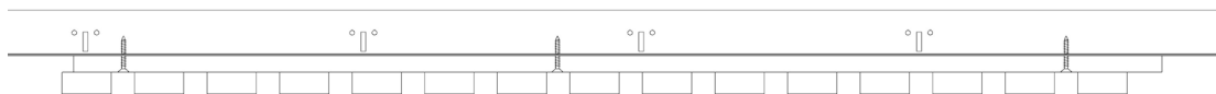
Figure 2. Vue en coupe - Fixation directe d'un panneau HARMONY avec des vis sur un système de suspension.
